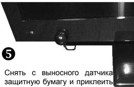
Снять с выносного датчика защитную бумагу и приклеить его на переднюю панель телевизора
